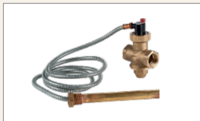
R144ST Thermische veiligheidsklep met manuele aftap. Zodra de watertemperatuur van de ketel met vaste brandstof te hoog oploopt verdampt de vloeistof in de voeler en wordt de veiligheidsklep geopend zodat de secundaire watercirculatie de keteltemperatuur begrenst.
