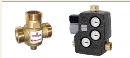
R157A Thermostatisch anti-condensatiemengventiel en R586AC anti-condensatiepompgroep om de temperatuur van de retourvloeistof te regelen. Dit beperkt de condensatie van de waterdamp in de verbrandingsgassen, wat de efficiëntie van de ketel ten goede komt.
