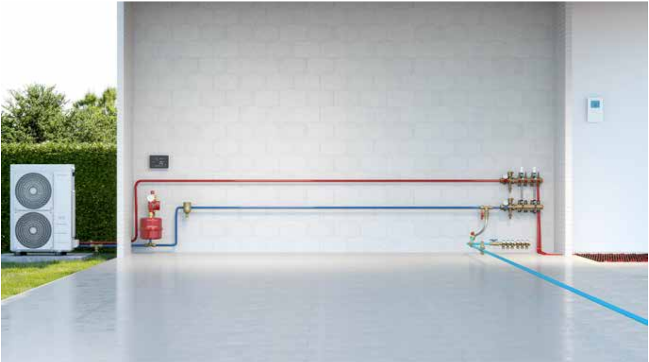
1. Schema voor warmtepomp zonder sanitaire boiler - zonder buffervat
