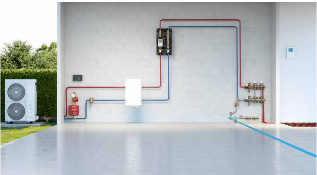
2. Schema voor warmtepomp zonder sanitaire boiler - met buffervat
