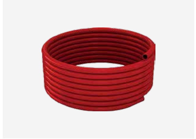
R978 PE-RT - Tube PE-RT avec barrière anti-oxygène EVOH intermédiaire (5 couches) pour système basse température - Couleur rouge.
