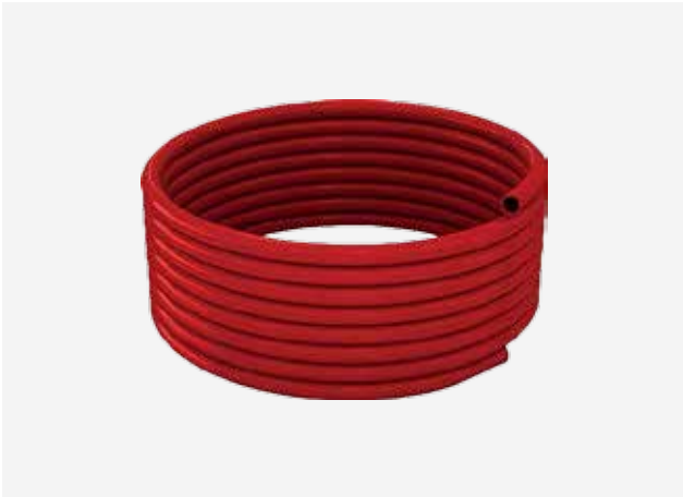
R996T PEX - Tube PE-Xb (tube polyéthylène avec réticulation au silane) à flexibilité élevée, Equipé d'une barrière anti-oxygène sur la partie extérieure - 3 couches - Couleur rouge.
