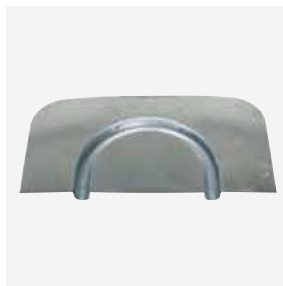
K802B - Warmtegeleidingsbocht - 125x245x0,5mm - Verlegafstand 125mm - Te gebruiken in combinatie met meerlagenbuis R977 Ø14mm - Vervaardigd uit verzinkt staal.
