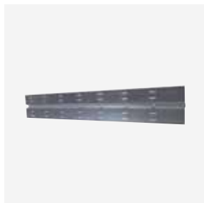
K802A - Warmtegeleidingsprofiel - 750x120x0,5mm - Te gebruiken in combinatie met meerlagenbuis R977 Ø14mm - Vervaardigd uit verzinkt staal.
