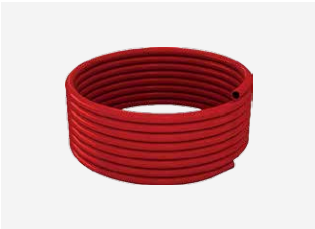
R996T PEX - PE-Xb buis (polyethyleen kunststofleiding met silaan vernetting) met hoge flexibiliteit - Uitgerust met zuurstofdichte mantel aan de buitenzijde - 3 lagen - Kleur : rood.
