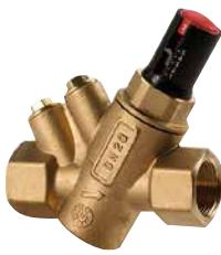
Automatische debietregelaar voor systemen met variabel debiet · kunststofpatroon met dubbele schaal (schaal 1 - 5 en decimale verdeling 1 - 9) voor nauwkeurig instelling van gewenst debiet · inwendige Schroefdraad x inwendige Schroefdraad · 2 extra aansluitingen inwendige Schroefdraad 1/4" voor meetnippels P206Y001 voor meten differentiaaldruk · vervaardigd uit messing
