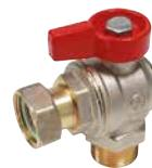
Kogelkraan met volle doorlaat · haaks model · met losse wortel · inwendige schroefdraad x uitwendige schroefdraad · bediening door rood vlinderhandwiel met 1 vleugel · beveiligd door hologram · vervaardigd uit messing · vernikkeld
