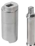
Asverlenging voor kogelkranen · laat toe het kraanlichaam van isolatie te voorzien zonder de bediening te hinderen · montage mogelijk na het plaatsen van de kogelkraan · vervaardigd uit messing · verchromd
