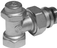
Voetventiel · zelfdichtend puntstuk · haaks model · met vul- en aftapmogelijkheid (in combinatie met afaathulpstuk R700) · voorinstelling met geheugenschroef · vervaardigd uit messing · verchroomd
