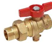
Kogelkraan met 3-delig puntstuk · volle doorlaat · inwendige schroefdraad x 3-delig puntstuk met uitwendige schroefdraad · bediening door rood vlinderhandwiel, beveiligd door hologram · uitgerust met inwendige schroefdraad M10 x 1 voor voeler (geleverd met blindstop) · vervaardigd uit messing
