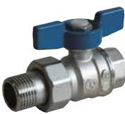
Kogelkraan met 3-delig puntstuk · volle doorlaat · inwendige schroefdraad x 3-delig puntstuk met uitwendige schroefdraad · bediening door rood of blauw vlinderhandwiel, beveiligd door hologram · vervaardigd uit messing · verchromd
