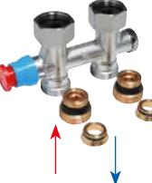
Tweeëpipsonderblok 100% met vloeraansluiting (hartafstand 50 mm) · recht model · voor radiatoren met centrale onderaansluiting · thermostatiserbaar met elementen R460 / R468 / R470 · aansluiting radiator via wortel 3/4" met inwendige Schroefdraad of verloopstuk met 1/2" uitwendige schroefdraad · aansluiting leidingen via Eurocone 3/4" · vervaardigd uit messing · verchroomd.
