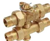
Drieweg zoneventiel met 3-delige puntstukken en vlakke afdichtingsringen · uitgerust met kogel · hartafstand tussen aanvoer en retour 46 mm (3/4") of 54 mm (1") · de bypass is instelbaar met zeskantsleutel 8 mm en regelbaar in lengte · alle aansluitingen via uitwendige schroefdraad · max. gebruikstemperatuur 110 °C · max. gebruiksdruk 10 bar · te gebruiken in combinatie met de servomotoren K270 en K272 · vervaardigd uit messing
