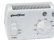
Thermostat d'ambiance électronique · montage sur le mur · alimentation 230 V · plage de fonctionnement 5 °C - 35 °C · fonction été/hiver · régime de nuit via contact externe · à utiliser en combinaison avec servomoteurs K270 / K272 ou électrovannes R473 / R478
