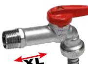
Dubbeldienstkraan met slangpilaar · standaard doorlaat · uitwendige Schroefdraad x slangpilaar · temperatuurbereik 5 °C - 90 °C · max. gebruiksdruk 10 bar (voor water bij 20 °C) · bediening door rood vlinderhand wiel met 1 vleugel · beveiligd door hologram · vervaardigd uit messing · verchromd
