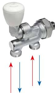
Eénpijp-tweeppijpsaansluitcombinatie met vloer- of muuraansluiting (hartafstand 35 of 50 mm) · zijdelingse aansluiting van het verwarmingslichaam · handwiel oriënteerbaar over 180° · thermostatiserbaar · te gebruiken in combinatie met inspuitbus R171C 11 mm voor model 1/2" en R171C 12 mm voor model 3/4" · adaptieraansluiting · vervaardigd uit messing · verchroomd · geleverd zonder inspuitbus R171C en adapters
