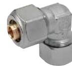
Klemkoppeling voor kunststofbuis en kunststof meerlagenbuis met aluminium tussenlaag · haaks model · klemkoppeling x klemkoppeling · vervaardigd uit messing · verchroomd
