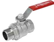
Kogelkraan met volle doorlaat · inwendige schroefdraad x uitwendige schroefdraad · bediening door rode hendel, beveiligd door hologram · vervaardigd uit messing · verchroomd
