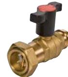
Vanne à boisseau sphérique avec passage intégral pour le raccordement de circulateur · écrou prisonnier avec joint plat x raccord à sertir pour tube cuivre / INOX et acier C (utiliser avec mâchoires type 'V' ou 'M' ou 'SA') · commande par manette papillon et prolongement plastique · température max. d'utilisation 110 °C · pression max. d'exercice 28 bar (eau à 20 °C) · fabriqué en laiton · livré avec flow check R288
