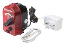
Servomoteur avec régulateur de température constante intégré pour vannes mélangeuses R296 / R297 et groupes de pompes universels R586R · alimentation 24 V (livré avec transformateur 230 VAC - 24 VAC) · équipé d'un écran LCD pour l'affichage de la température désirée · pour une régulation autonome · possibilité de commande manuelle · longueur utile du câble d'alimentation électrique 2 m (2 x 0,5 mm<sup>2</sup>) · sonde 1,5 m · classe de protection IP44 · montage par système de clipsage
