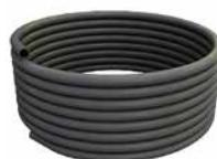
Polybutyleen kunststofleiding · uitgerust met tussenliggend zuurstofdicht scherm - 5 lagen · conform met DIN 16968 - DIN 16837 - DIN 4726 · kleur : grijs · toepassing in vloersystemen voor verwarming en koeling
