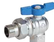
Kogelkraan met volle doorlaat · haaks model · 3-delig puntstuk met uitwendige schroefdraad x inwendige schroefdraad · bediening door rood vlinderhandwiel, beveiligd door hologram · vervaardigd uit messing · verchromd
