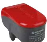
Servomotor voor zoneventielen R276 / R277 / R278 / R279 / R279D · uitvoering 24 V of 230 V · uitgerust met eindeloopcontact · beweging over 90° in 40 seconden · max koppel 10 Nm · beschermingsgraad IP54 · met positieindicator · montage op het zoneventiel via clipssysteem.
