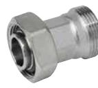
Verlengstuk voor alle radiatorkranen, aansluitcombinaties en voetventielen met adapteraansluiting 16, 18 3/4" of 3/4"E · lengte 30 mm · losse wartel met inwendige schroefdraad adapteraansluiting 16, 18, 3/4" of 3/4"E x uitwendige schroefdraad adapteraansluiting 16, 18, 3/4" of 3/4"E · vervaardigd uit messing
