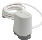
Elektro-afsluitelement - stroomloos open · voeding 24 V of 230 V · aan/uit regeling · model M met bijkomende micro-switch (4-draads ipv 2-draads 0,75 mm²) · nuttige lengte snoer 1,5 m · beschermingsgraad IP40 · te gebruiken met thermostatiserbare kranen, zoneventielen R291 - R292 en voorgemonteerde verdelers
