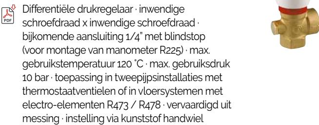
Vanne différentielle · filet intérieur x filet intérieur · raccordement supplémentaire 1/4" avec bouchon (pour montage du manomètre R225) · température max. d'utilisation 120 °C · pression max. d'exercice 10 bar · application dans installations bitubes avec robinets thermostatisés ou dans installations sol avec électrovannes R473 / R478 · fabriqué en laiton · réglage par volant plastique
