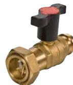
Vanne à boisseau sphérique avec passage intégral pour le raccordement de circulateur · écrou prisonnier avec joint plat x raccord à sertir pour tube cuivre / INOX et acier C (utiliser avec mâchoires type 'V' ou 'M' ou 'SA') · commande par manette papillon et prolongement plastique · température max. d'utilisation 110 °C · pression max. d'exercice 28 bar (eau à 20 °C) · fabriqué en laiton · livré avec flow check R288
