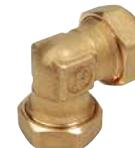
Knelkoppeling met konische ring en O-ring voor koperbus en dunwandige stalen buis · haaks model · knelkoppeling x knelkoppeling · vervaardigd uit messing
