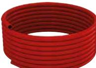
PE-Xb kunststofleiding (polyethyleen kunststofleiding met silaan vernetting) met hoge flexibiliteit · uitgerust met zuurstofdichte EVOH-mantel aan de buitenzijde - 3 lagen · conform EN ISO 15875 - DIN 16892 - DIN 4726 · kleur : rood · toepassing in vloersystemen voor verwarming en koeling
