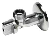
Hoekstopkraan met rozet standaard doorlaat · uitwendige Schroefdraad x uitwendige Schroefdraad · temperatuurbereik 5 °C - 70 °C (kortstondige pieken tot 90 °C) · max. gebruiksdruk 10 bar (voor water bij 20 °C) · vervaardigd uit messing · verchromd
