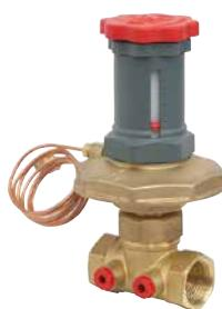
Drukverschilregelaar voor constant drukverschil · dubbele schaal, instelbaar voor of na montage: 'LOW' van 5 tot 30 kPa en 'HIGH' van 25 tot 60 kPa · geleverd met capillaire 1 m voor aansluiting op het strangregelventiel R206B of R206B-1 in de aanvoer · temperatuurbereik van -20 °C (met glycol) tot 110 °C · nominale druk PN16 · 2 extra aansluitingen voor meetnippels P206Y001 (geleverd met 2 blindstoppen) · inwendige Schroefdraad x inwendige Schroefdraad · vervaardigd uit ontzinkingsvrij messing
