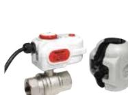
Tweeweg zoneventiel · uitgerust met kogel (volle doorlaat), servomotor K272 (beweging over 90° in 60°) - beschermingsgraad IP65 - uitvoering 24 V of 230 V) en isolatie in vernet polyethyleenschuim · temperatuurbereik -5 °C (met glycol) - 110 °C · max. gebruiksdruk PN40 · inwendige chroefdraad x inwendige schroefdraad · vervaardigd uit messing · vernikkeld
