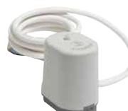
Electrovanne - normalement ouverte · alimentation 24 V ou 230 V · régulation tout ou rien · modèle M avec micro-switch supplémentaire (4 fils au lieu de 2 fils 0,75 mm<sup>2</sup>) · longueur utile du câble 1,5 m · classe de protection IP40 · à utiliser avec les robinets thermostatisables, les vannes de zone R291 - R292 et les collecteurs prémontés
