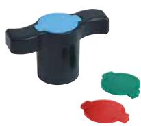
Asverlenging voor kogelkranen · te gebruiken in combinatie met thermometer R540F · laat toe het kraanlichaam van isolatie te voorzien zonder de bediening te hinderen · montage mogelijk na het plaatsen van de kogelkraan · vervaardigd uit kunststof
