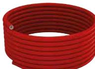
PE-Xa kunststofleiding (polyethyleen kunststofleiding met peroxide vernetting) met hoge flexibiliteit · uitgerust met zuurstofdichte EVOH-mantel aan de buitenzijde - 3 lagen · conform EN ISO 15875 - DIN 16892 - DIN 4726 · kleur : rood · toepassing in vloersystemen voor verwarming en koeling
