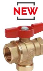
Kogelkraan met ingebouwde filter · volle doorlaat · inwendige schroefdraad x inwendige schroefdraad · bediening door rood vlinderhandwiel, beveiligd door hologram · filter in INOX 500 µm · vervaardigd uit messing
