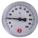
Thermometer met dompelbuis (incl. borgschroef) · centrale rugaansluiting met uitwendige schroefdraad 3/8" of 1/2" · Model 3/8": diameter 40 mm en schaal van 0°C tot 80°C · Model 1/2": diameter 63 mm en schaal van 0°C tot 120°C · R540Y015: thermometer met clips, schaal van 0 °C tot 120 °C / Ø40 mm voor R269T · R540Y016: thermometer met clips, schaal van 0 °C tot 120 °C / Ø40 mm + °F voor R583FK, R583DK en BE583Y001
