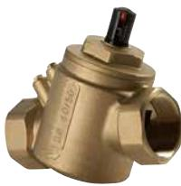
Pressure Independent Control Valve (PICV), combinaison d'un stabilisateur automatique de débit pour systèmes à débit variable et d'une vanne de régulation · réglage manuel ou automatique du débit · à utiliser en combinaison avec le servomoteur K281 ou l'électrovanne K281E · filet intérieur x filet intérieur · 2 raccordements supplémentaires 1/4" pour nipples de mesure P206Y001 (livré avec 2 bouchons) · température max. d'utilisation 120 °C · pression nominale PN25 · fabriqué en laiton
