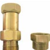
Cartouche thermostatique pour la fermeture automatique du circuit d'un plancher rafraîchissant dès que la température de l'eau est en dessous de 18 °C · pour les circuits des pièces humides (p.ex. salle de bain) afin d'éviter la formation de condensation· raccordement 3/4" Eurocône · s'installe sur le départ des circuits · utilisation en combinaison avec les adaptateurs R179EX124 pour tuyau synthétique / tube multicouches (16 x 2)
