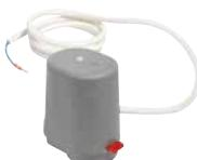
Elektro-afsluitelement - stroomloos gesloten · voeding 24 V of 230 V · aan/uit regeling · model M met bijkomende micro-switch (4-draads ipv 2-draads 0,75 mm²) · nuttige lengte snoer 1 m · beschermingsgraad IP40 · te gebruiken met thermostatiserbare kranen, zoneventielen R291 - R292 en voorgemonteerde verdelers
