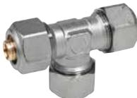
Klemkoppeling voor kunststofbuis en kunststof meerlagenbuis met aluminium tussenlaag · T-stuk · 3 x klemkoppeling · vervaardigd uit messing · verchroomd
