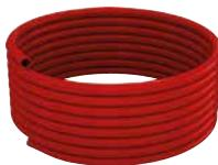
PE-RT kunststofleiding (Polyethylene pipes of Raised Temperature Resistance) met hoge flexibiliteit · toepassing in lage temperatuur vloer- en plafondinstallaties (voor koeling en verwarming) · 5 lagen · uitgerust met een tussenliggende zuurstofdichte EVOH-mantel · conform EN ISO 22391
