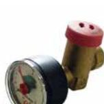
Overdrukventiel met manometer R225 (diameter 50 mm - schaal van 0 tot 4 bar) · compact model · 3 bar · inwendige schroefdraad x inwendige schroefdraad · temperatuurbereik 5 °C - 110 °C · nominale druk PN10 · vervaardigd uit messing · kunststof handwiel
