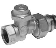
Voetventiel · zelfdichtend puntstuk · recht model · met vul- en aftapmogelijkheid (in combinatie met afaathulpstuk R700) · voorinstelling met geheugenschroef · vervaardigd uit messing · verchroomd
