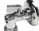
Hoekstopkraan voor wasmachine/vaatwasmachine met rozet · standaard doorlaat · uitwendige Schroefdraad x uitwendige Schroefdraad · temperatuurbereik 5 °C - 70 °C (kortstondige pieken tot 90 °C) · max. gebruiksdruk 10 bar (voor water bij 20 °C) · vervaardigd uit messing · vernikkeld
