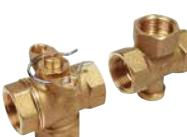
Drieweg zoneventiel · uitgerust met kogel · de bypass is instelbaar met zeskantsleutel 8mm · alle aansluitingen via inwendige schroefdraad · max. gebruikstemperatuur 110 °C · max. gebruiksdruk 10 bar · te gebruiken in combinatie met de servomotoren K270 en K272 · vervaardigd uit messing
