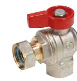
Kogelkraan met volle doorlaat · haaks model · met losse wortel · inwendige schroefdraad x inwendige schroefdraad · bediening door rood vlinderhandwiel met 1 vleugel · beveiligd door hologram · vervaardigd uit messing · vernikkeld
