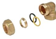
Knelkoppeling met konische ring en O-ring voor koperbuis en dunwandige stalen buis · haaks model · inwendige schroefdraad x knelkoppeling · vervaardigd uit messing
