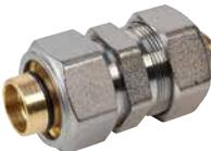
Klemkoppeling voor kunststofbuis en kunststof meerlagenbuis met aluminium tussenlaag · recht model / verloopstuk · klemkoppeling x klemkoppeling · vervaardigd uit messing · verchroomd
