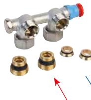
Corps bitube 100% pour radiateurs pour raccordement mural (entraxe 50 mm) · modèle équerre · pour radiateurs avec raccordement central · thermostatisable avec les têtes R460 / R468 / R470 · raccordement radiateur par écrou 3/4" avec filet intérieur ou une réduction avec filet extérieur 1/2" · raccordement tuyaux par alésage Eurocône 3/4" · fabriqué en laiton · chromé
