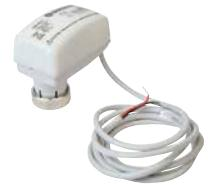
Servomotor voor mengkranen R298N en PICV R206A-1 en R206AM · voeding 24 V · aanduiding positie door LED op bovenzijde behuizing · aansluiting op kraanlichaam via wortel M30 x 1,5 · beschermingsgraad IP40 (K281X022), IP43 (K281X012) of IP54 (K281X032 - 042)
