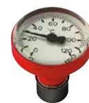
Thermometer · rood / blauw · centrale rugaansluiting · schaal 0 - 120 °C · diameter 40 mm · te gebruiken in combinatie met asverlenging R749F voor de kogelkranen van de serie R851VT / R851VTS / R853VT / R854VT / R859VT
