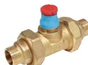
Tweeweg zoneventiel met 3-delige puntstukken en vlakke afdichtingsringen · uitgerust met rubberen klep · aansluitingen via uitwendige Schroefdraad · max. gebruikstemperatuur 110 °C · max. gebruiksdruk 10 bar · te gebruiken in combinatie met elektro-afsluitelementen van de series R473 en R478 · vervaardigd uit messing
