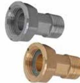
Koppeling · uitwendige Schroefdraad x losse wartel met vlakke afdichtingsring · toepassing voor de aansluiting van watermeters · mogelijkheid tot verzegeling van de wartel · temperatuurbereik 5 °C - 110 °C · max. gebruiksdruk 10 bar · vervaardigd uit messing
