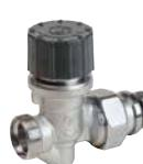
Robinet thermostatisable avec équilibrage dynamique · modèle droit · douille auto-étanche · raccordement via adaptateur Eurocône 3/4" · robinet équipé d'un filet M30 x 1,5 pour têtes thermostatiques R460H-R468H-R470H · fabriqué en laiton chromé
