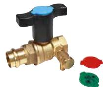
Kogelkraan met volle doorlaat, aftapkraan en persaansluiting voor zachte, halfharde en harde koperen buis / RVS en C-staal buis · persaansluiting (gebruiken met persbekken type 'V', 'SA' of 'M') x inwendige schroefdraad · model anti-legionella · O-ring conform EN681-1 voor drinkwater en verwarming · geleverd met groen / rood / blauw dopje voor aanduiding toepassing · bediening door vlinderhandwiel en kunststof asverlenging · vervaardigd uit messing
