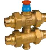
Drieweg zoneventiel met 3-delige puntstukken en vlakke afdichtingsringen · uitgerust met rubberen klep · hartafstand tussen aanvoer en retour 55 mm · de bypass is instelbaar met zeskantsleutel 8 mm en regelbaar in lengte · alle aansluitingen via uitwendige Schroefdraad · max. gebruikstemperatuur 110 °C · max. gebruiksdruk 10 bar · te gebruiken in combinatie met elektro-afsluitelementen van de series R473 en R478 · vervaardigd uit messing
