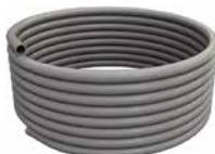
Polybutyleen kunststofleiding · uitgerust met tussenliggend zuurstofdicht scherm - 5 lagen · conform met DIN 16968 - DIN 16837 - DIN 4726 · kleur : grijs · toepassing in vloersystemen voor verwarming en koeling
