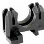
Clips pour treillis K100 (épaisseur 3 mm) · approprié pour tuyaux plastiques 16 mm - 17 mm · à utiliser en combinaison avec la clé R863Y501
