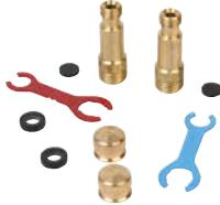
Set met 2 meetnippels voor meten van differentiaaldruk over automatische debietregelaar R206A, PICV R206AM, statisch strangregelventiel R206B en drukverschilregelaar R206C · uitwendige Schroefdraad 1/4" · vervaardigd uit messing · uitgerust met rubberen afdichting voor afdichting op naald van meetapparaat
